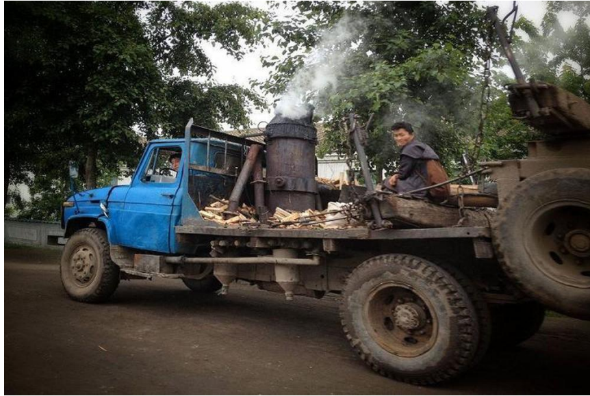
Một xe vận tải chạy bằng than củi tại Bắc Hàn hiện nay (ảnh: Internet)
